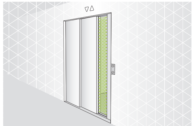
Aplicación en dinámico – haces cruzados activos hasta el completo cierre de la puerta
