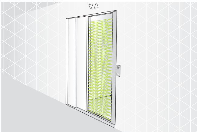
Aplicación en dinámico – haces cruzados activos hasta el completo cierre de la puerta
